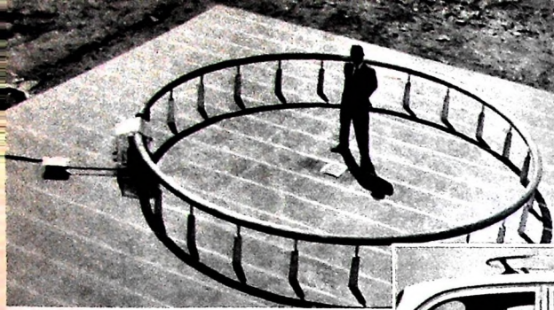
Bild 1. DDRR-Antenne (oben) mit fernsteuerbarem Abstimmkondensator und (rechts) ein kleiner Typ für Kraftfahrzeuge
