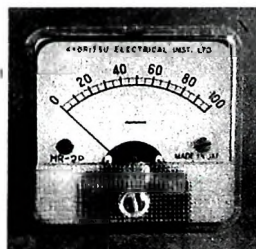
Bild 6. Das für den Aussteuerungsmesser verwendete Meßgerät
